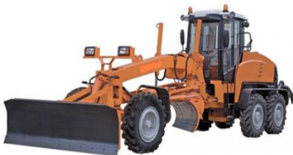
3.7-сурет. Автогрейдерлер: а-жалпы көрініс; б-пландағы қайырманың бұрылу сұлбасы; в-доңғалақтардың бүйіреңкею сұлбасы; г-қайырманың бүйір шығымының сұлбасы
