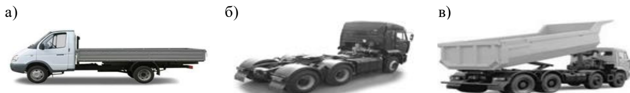
2.1-сурет. Жүк таситын автомобильдер: а - ашық платформалы; б - ер-ілінісуі құрылғылы тартқыш; в - өзіаударғыш
